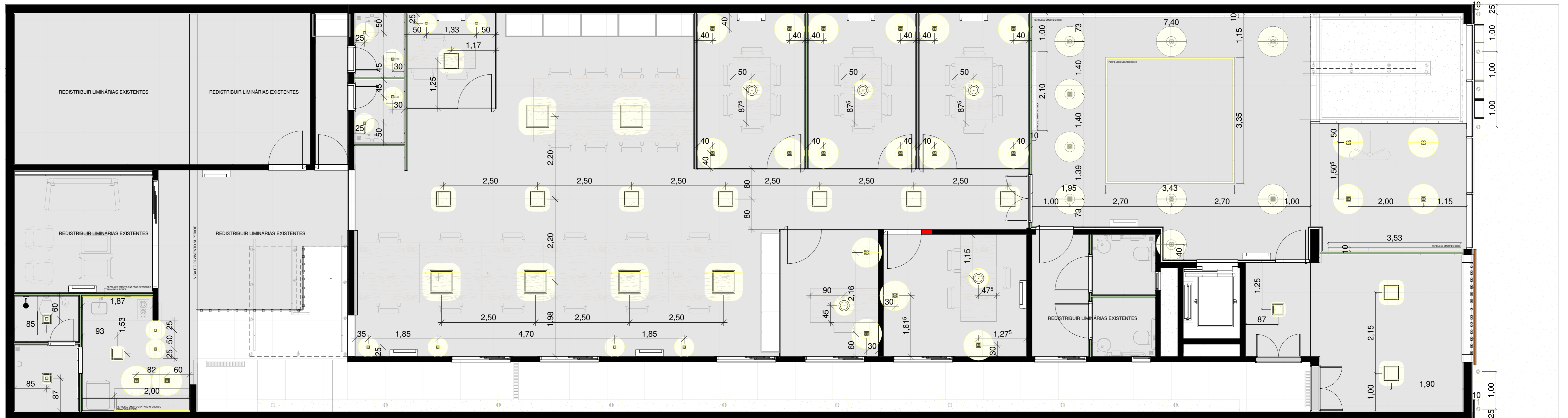
PLANTA LUMINOTÉCNICA TÉRREO ESCALA - 1 : 50
